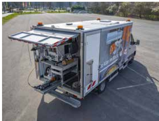
Kanalinspektionsfahrzeug im Einsatz in Hamm vor der Maxipark Arena mit Einsicht der Ausrüstung. Foto: Klaus Baumers/EGLV
